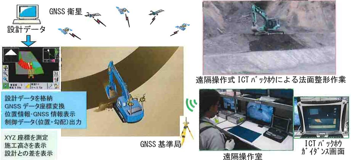
図-4 ICTバックホウの無人化施工イメージ
