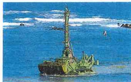
写真-1 水陸両用ブルドーザ (D155W型)
